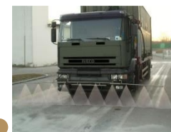
Descontaminação de Terreno
